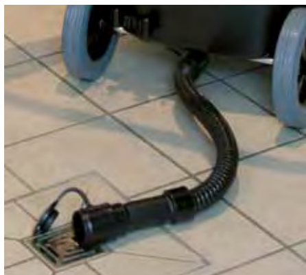
Schmutzwasser-Ablassschlauch zum bequemen, restlosen Entleeren des Behälters.
