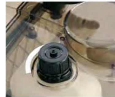
Ein separater Tank ermöglicht den Betrieb mit Entschäumer und garantiert damit ein kontinuierliches Arbeiten.
