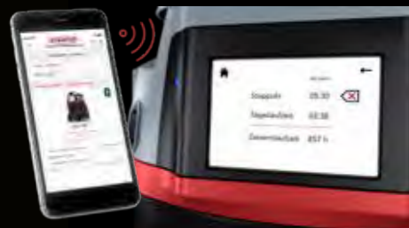
Auslesen/Synchronisieren von Gerätedaten über Bluetooth-Schnittstelle.
